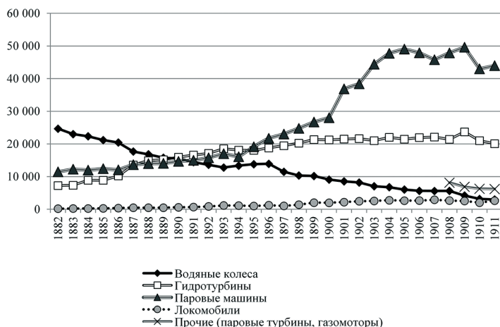
Рис. 5. Совокупная мощность основных типов двигателей на заводах черной металлургии Урала в 1884–1911 гг.
